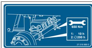
Cet autocollant indique que le raccordement de ressort doit être serré la première fois après 10 heures de fonctionnement, puis toutes les 200 heures de fonctionnement à un couple de serrage de 650 Nm, voir le manuel pour techniciens de service.
