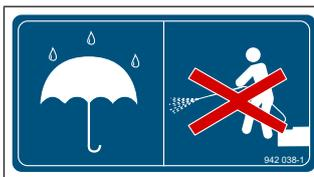
Les zones repérées par ce signe d'information doivent être protégées des projections d'eau. Le jet d'eau d'un nettoyeur à haute pression ne doit en particulier pas être dirigé sur les pa-liers et les composants électriques/électroniques.
