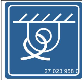
La machine comprend des points d'arrimage identifiés par cet autocollant, voir le chapitre Conduite et transport, « Arrimer la machine ».
