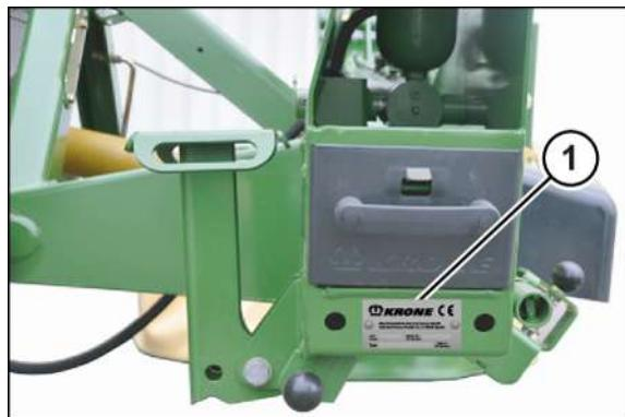
Параметры машины приведены на фирменной табличке (1). Фирменная табличка установлена спереди на несущей балке.
