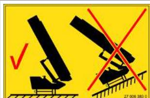
**Опасность опрокидывания машины**
