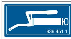
На машине имеются несколько точек смазки, которые необходимо регулярно смазывать, *см. Страница 117*. Скрытые точки смазки дополнительно обозначены этой указательной наклейкой.
