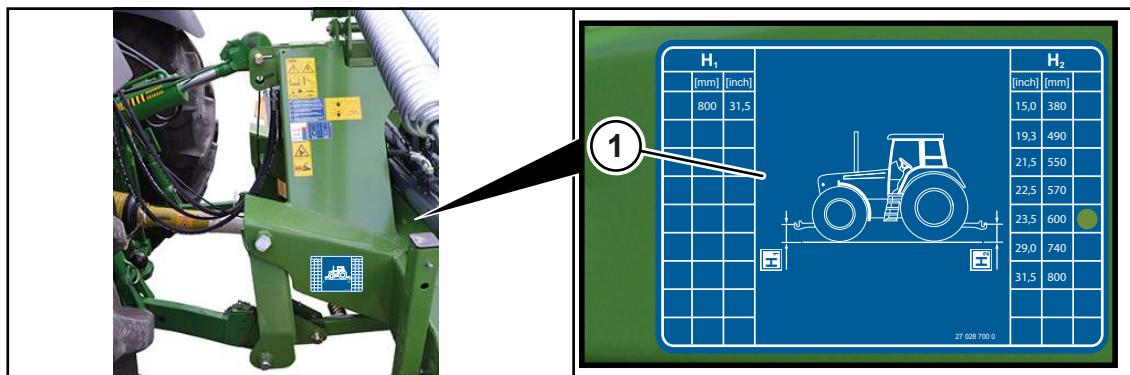
После подсоединения машина для косьбы должна быть установлена на подходящую высоту.
