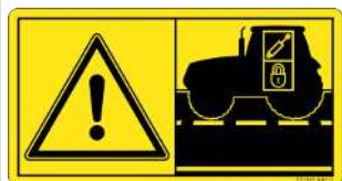
**Опасность из-за незаблокированных управляющих клапанов трактора**
