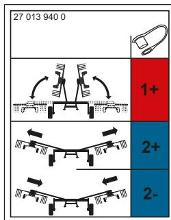
Наклейка отмечает возможные гидравлические подключения машины. Дополнительная информация о подсоединении гидравлических шлангов: [см. Страница 58](#).
