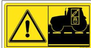
**Опасность из-за незаблокированных управляющих клапанов трактора**
