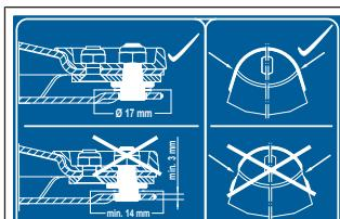
**В модификации с быстродействующим ножевым замком**
