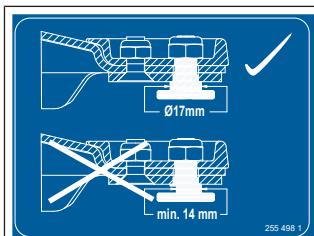
**В модификации с резьбовым ножевым замком**
