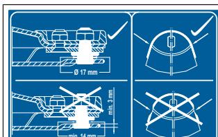
**В модификации с быстродействующим ножевым замком**
