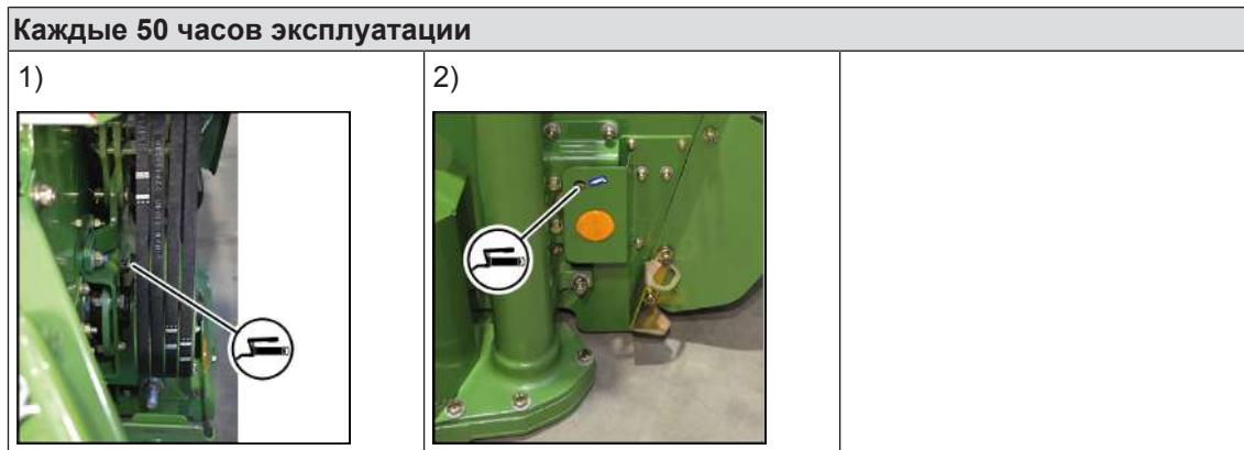
Дополнительные точки смазки при исполнении «Буксируемый»
