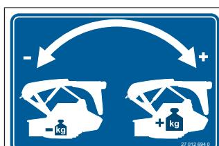
Наклейка указывает на то, что пружинную разгрузку можно отрегулировать вследствие приведения в действие ходового винта.
