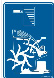
Степень плющения может изменяться путем регулировки подготовительного щитка с помощью рычага.
