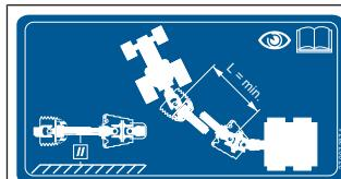
Наклейка расположена рядом с карданным валом и указывает, что при регулировке карданного вала должна быть соблюдена инструкция по эксплуатации, [см. Страница 48](#).
