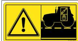
**Опасность из-за незаблокированных управляющих клапанов трактора**
