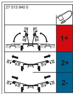
Наклейка отмечает возможные гидравлические подключения машины. Дополнительная информация о подсоединении гидравлических шлангов: [см. Страница 56](#).
