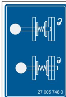
Указательный знак находится на устройствах блокировки со стяжным пальцем и показывает, какая блокировка открыта или закрыта.
