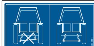
Эта наклейка расположена на монтажной опоре и указывает на необходимость одинаковой настройки нижних тяг, чтобы обеспечить горизонтальное положение машины при монтаже.
