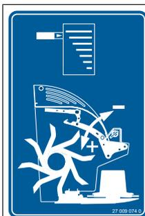
Степень плющения может изменяться путем регулировки подготовительного щитка с помощью рычага.
