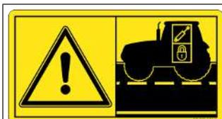
**Опасность из-за незаблокированных управляющих клапанов трактора**
