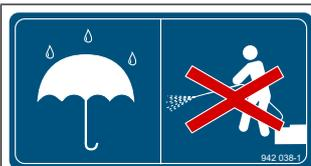
Les zones repérées par ce signe d'information doivent être protégées des projections d'eau. Le jet d'eau d'un nettoyeur à haute pression ne doit en particulier pas être dirigé sur les pa-liers et les composants électriques/électroniques.
