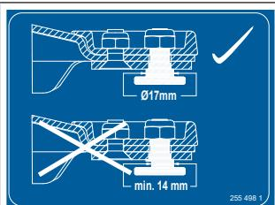
**В модификации с резьбовым ножевым замком**
