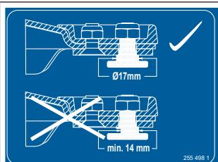
**В модификации с резьбовым ножевым замком**
