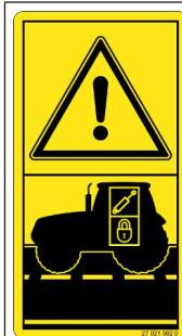
**Опасность из-за незаблокированных управляющих клапанов трактора**
