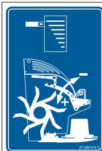
Le degré de conditionnement peut être modifié par le réglage de la tôle de conditionnement via le levier.
