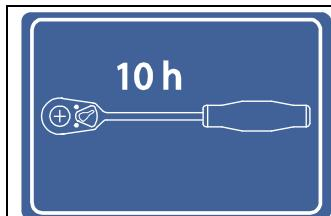
После первых 10 часов эксплуатации необходимо проверить момент затяжки болтов, см. в главе "Таблица технического обслуживания" раздел "Моменты затяжки".
