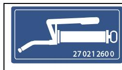
На машине имеются несколько точек смазки, которые необходимо регулярно смазывать, см. главу "Техническое обслуживание – смазывание". Скрытые точки смазки дополнительно обозначены этим указательным знаком.
