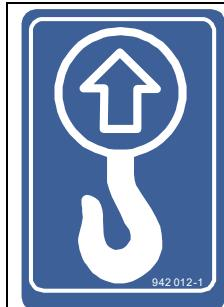
На машине имеются точки подъема, обозначенные этим указательным знаком, см. в главе "Движение и транспортировка" раздел "Подъем машины".
