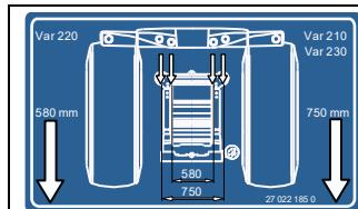
Питающие пластины в зависимости от типа кормоуборочного комбайна могут быть смонтированы в различных позициях. Монтажное положение питающих пластин можно определить с помощью указательного знака, см. в главе "Описание машины" раздел "Обзор различных видов адаптации".
