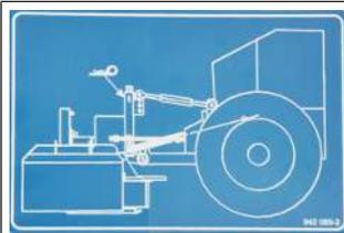
L'autocollant indique qu'il convient de bloquer le mécanisme de verrouillage avec la goupille à ressort après l'accouplement de la faucheuse frontale.
