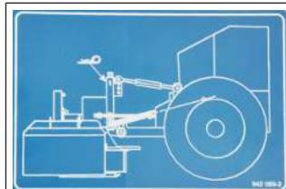
Наклейка указывает на то, что после подсоединения фронтальной косилки необходимо застопорить шплинтом блокирующий механизм.
