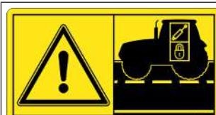
**Nebezpečí při nezajištěných řídicích ventilech traktoru**
