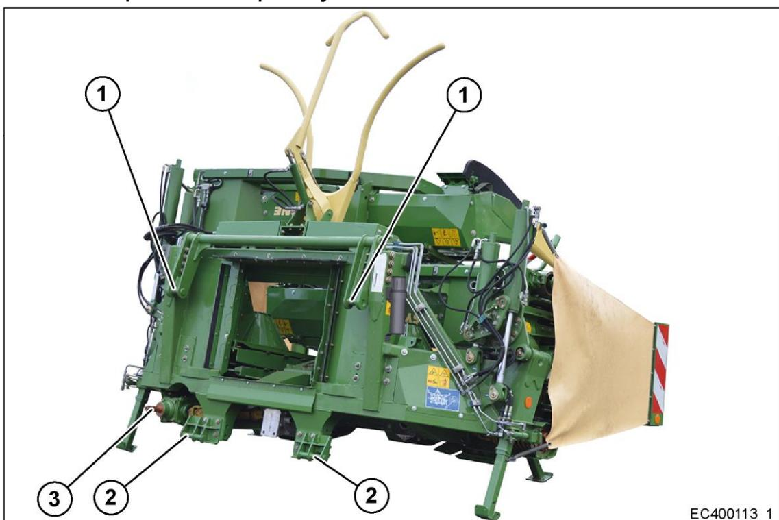
Obr. 6 Příklad: EasyCollect 750-3 s přizpůsobením kyvného rámu
