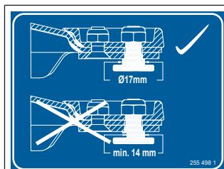
**U provedení se šroubovým uzavěrem nožů**
