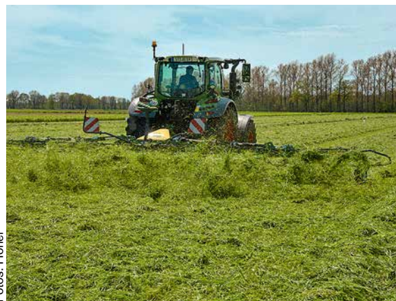
△ Links: Auf einigen Testpartellen kam ein Wender zum Einsatz. Seine Arbeitsbreite passte zu der der Mähkombis. Rechts: Mit Drehmomentmessnarben haben wir die Leistung gemessen.
