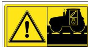
**Nebezpečí při nezajištěných řidicích ventilech traktoru**
