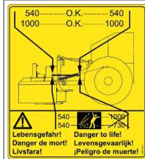
**Ohrožení života při překročení maximálního přípustného počtu otáček vývodového hřídele**
