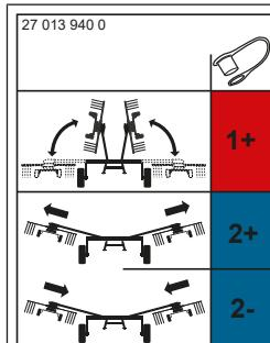
Samolepka ukazuje možné hydraulické spoje stroje. Pro další informace k připojení hydraulických hadic: [viz Strana 52](#).
