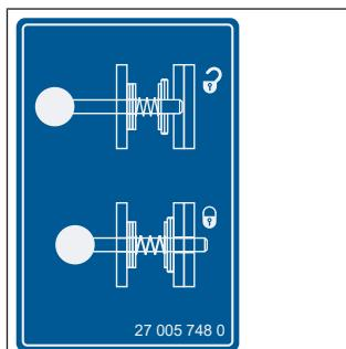
Tato samolepka se nachází na zajišťovacím mechanizmu vytahovacím čepem a uvádí, jak se zajišťovací mechanizmus otevírá nebo zavírá.
