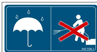
Prostory, které jsou označeny touto samolepkou, mají být chráněny před stříkající vodou. Obzvlášť nesmí být namířen proud vody vysokotlakého čisticího zařízení na ložiska a na elektrické/elektronické součásti.
