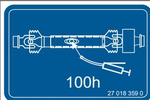
L'autocollant se trouve sur les arbres à cardan. Il indique qu'il faut lubrifier les arbres à cardan toutes les 100 heures de fonctionnement.
