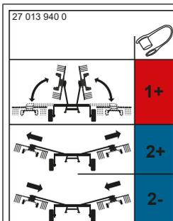
Cet autocollant indique les raccordements hydrauliques possibles de la machine. Pour davantage d'informations sur l'accouplement des flexibles hydrauliques : voir Page 57.
