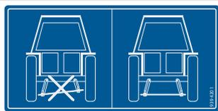
Cet autocollant se trouve sur le support d'attelage. Il indique que les bras inférieurs doivent être réglés à l'identique pour que le montage de la machine soit horizontal.
