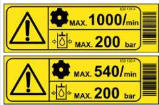
**Nebezpečí při překročení maximálního přípustného počtu otáček vývodového hřídele nebo maximálního přípustného provozního tlaku**
