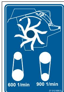
Nálepka informuje, že otáčky kondicionéru lze změnit přestavěním klínového řemenu.
