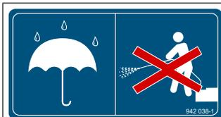
Les zones repérées par cet autocollant doivent être protégées des projections d'eau. Le jet d'eau d'un nettoyeur à haute pression ne doit en particulier pas être dirigé sur les paliers et le système électrique/les composants électroniques.
