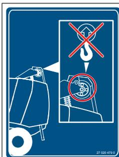
Aucun engin de levage ne peut être accroché sur le bras oscillant pour soulever la machine. Cela peut endommager la machine.
