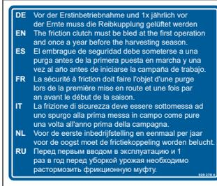
Cet autocollant indique que l'accouplement à friction doit être purgé avant la première mise en service et une fois par an, avant la saison.
