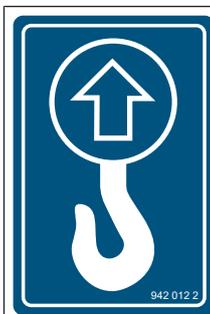
La machine comprend des points de levage identifiés par cet autocollant, [voir Page 72](#).
