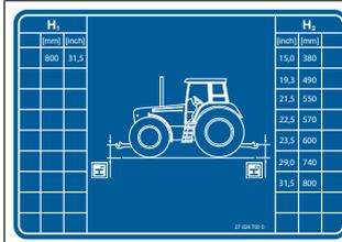
L'autocollant indique à quelle hauteur les bras inférieurs doivent être placés après l'accouplement de la machine.
