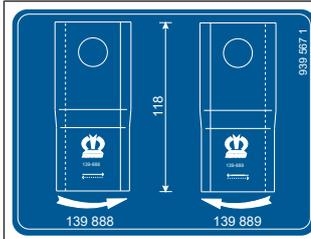
Cet autocollant comporte les numéros de commande des couteaux de rechange.
