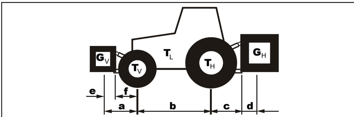
**Calcul du ballastage minimal à l'avant  $G_{V \min}$  pour les appareils montés à l'arrière et les combinaisons avant et arrière**
