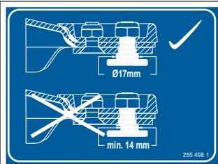
**Pour la version « Verrouillage à vis des couteaux »**
