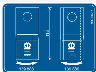
Cet autocollant comporte les numéros de commande des couteaux de rechange.
