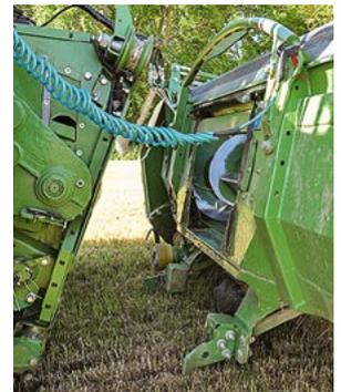
Die Pickup EasyFlow 300 S zeigte bis auf die Reibkupplung der Schnecke keine Schwächen. Zur Druckluftreinigung lassen sich Vorsatz und Häcksler mit gekuppelten Schläuchen etwas auseinanderfahren.
