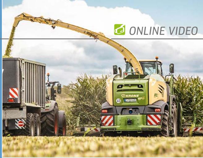
Mit zehnreihigem XCollect erreichte der BiG X 630 bei top Maisbeständen den Frischmassedurchsatz bis über 200 t/h. Fotos: Knötig (2), Fotos: Knötig (2), Küper (10), Werkbild (1)
