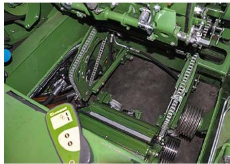
Dank „VariQuick“ sind kurze Umrüstzeiten zwischen Mais- und Gras- oder GPS-Einsatz möglich. Der Korncracker wird per Kettenzug abgelassen und auf Rollen seitlich herausgezogen.
