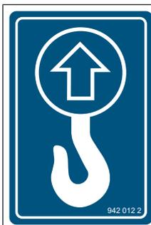
La machine comprend des points de levage identifiés par cet autocollant, [voir Page 186](#).
