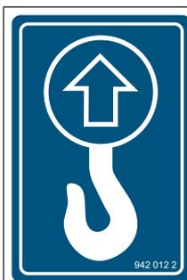
La machine comprend des points de levage identifiés par cet autocollant, [voir Page 187](#).
