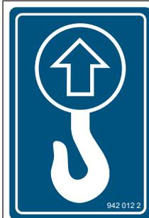
La machine comprend des points de levage identifiés par cet autocollant, *voir Page 69*.
