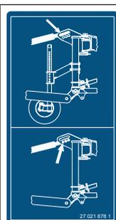
L'autocollant se trouve sur le support trois points et indique comment le bras supérieur doit être monté sur le support trois points, voir Page 52.
