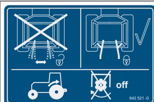
Lorsque la machine est attelée, les bras inférieurs sur le côté doivent être verrouillés. En marche arrière, la prise de force doit être désactivée.
