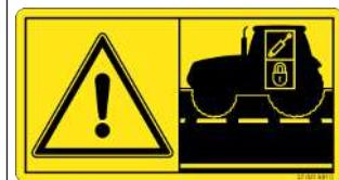
**Nebezpečí při nezajištěných řídicích ventilech traktoru**
