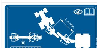
Samolepka se nachází v blízkosti klobového hřídele a uvádí, že je třeba dodržovat při přizpůsobení hřídele provozní návod, viz Strana 46.
