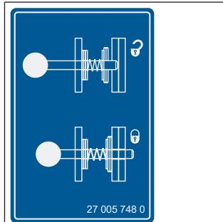
Tato samolepka se nachází na zajišťovacím mechanizmu vytahovacím čepem a uvádí, jak se zajišťovací mechanizmus otevří nebo zavírá.
