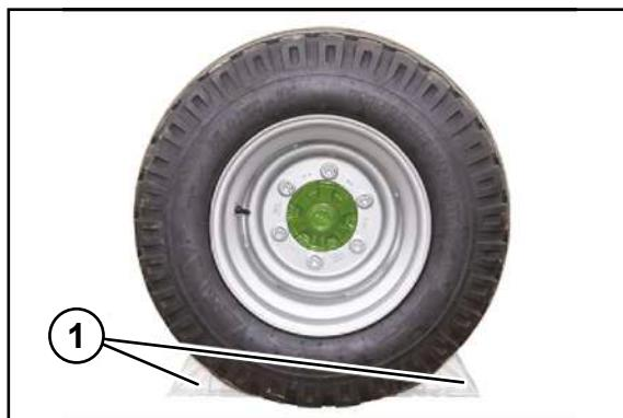
Zakládací klíny (1) zajišťují stroj proti samovolnému odjetí. Na stroji jsou umístěny 2 zakládací klíny.
