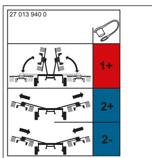
Samolepka ukazuje možné hydraulické spoje stroje. Pro další informace k připojení hydraulických hadic: viz Strana 54.
