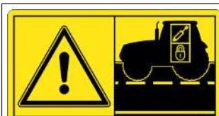
**Nebezpečí při nezajištěných řídicích ventilech traktoru**
