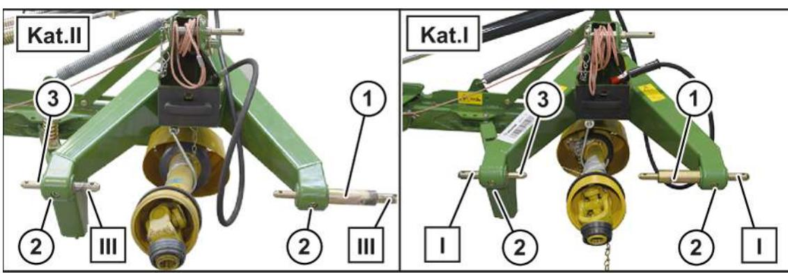
U širších traktorů nebo při pracích v kombinaci s čelním žacím ústrojím (pracovní šířka cca 2,8 – 3,2 m) se doporučuje přestavit čepy spodního táhla (1, 3) pro kulová pouzdra kategorie II (kat.II) do polohy (III). Pro kulová pouzdra kategorie I (kat. I) doporučujeme přesadit čepy spodního táhla (1, 3) do polohy (I).
