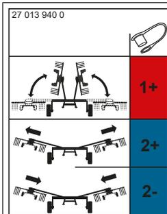
Cet autocollant indique les raccordements hydrauliques possibles de la machine. Pour davantage d'informations sur l'accouplement des flexibles hydrauliques : [voir Page 55](#).
