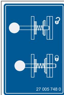
L'autocollant se trouve sur les verrouillages avec des boulons tirants et indique comment le verrouillage est ouvert ou fermé.
