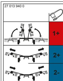
Наклейка отмечает возможные гидравлические подключения машины. Дополнительная информация о подключении гидравлических шлангов: [см. Страница 57](#).
