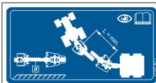
Наклейка расположена рядом с карданным валом и указывает, что при регулировке карданного вала должна быть соблюдена инструкция по эксплуатации, [см. Страница 47](#).
