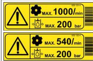
**Danger par dépassement de la vitesse de prise de force maximale autorisée ou de la pression de fonctionnement maximale autorisée**
