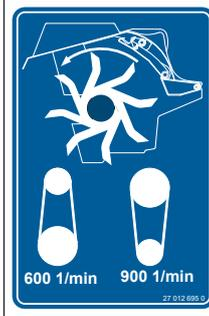
L'autocollant attire l'attention sur le fait que la vitesse de la conditionneuse peut être modifiée en déplaçant la courroie trapézoïdale.
