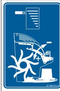
L'autocollant indique que le degré de conditionnement peut être modifié par le réglage de la tôle de conditionnement via le levier.
