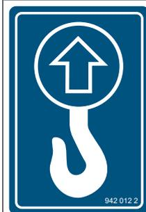
La machine comprend des points de levage identifiés par cet autocollant, *voir Page 83*.
