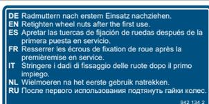
Эта наклейка указывает на то, что гайки колес необходимо дополнительно затягивать после первого применения.
