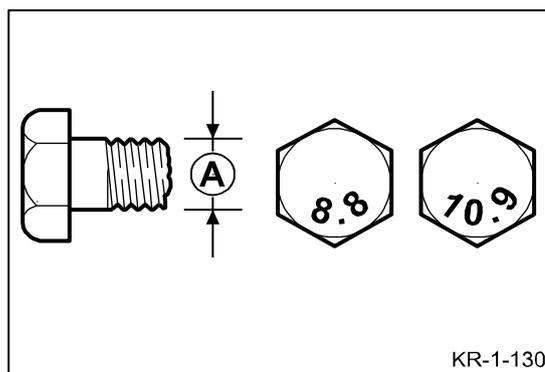
17.4.2 Vis filetées métriques avec filetage à pas fin
