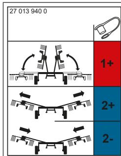
Samolepka ukazuje možné hydraulické spoje stroje. Pro další informace k připojení hydraulických hadic: *viz Strana 51*.
