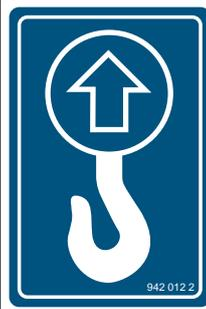
La machine comprend des points de levage identifiés par cet autocollant, voir Page 70.
