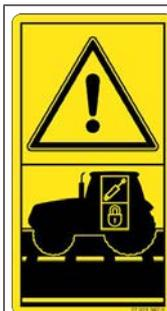
**Опасность из-за незаблокированных управляющих клапанов трактора**
