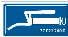
La machine comporte plusieurs points de lubrification, qui doivent être régulièrement lubrifiés, *voir Page 218.* Les points de lubrification non visibles directement sont repérés en complément par cet autocollant d'avertissement.
