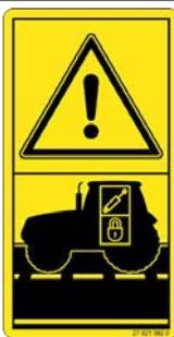
**Danger dû à des soupapes de commande non verrouillées du tracteur**
