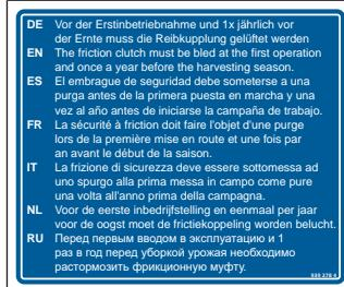
Tato nálepka uvádí, že se musí třecí spojka před prvním uvedením do provozu a jednou za rok před sezónou provzdušnit.
