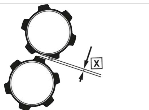
Odstup (X) válců se nastavuje šroubem (1) na pravé a levé straně. Aby nedošlo k vysokému opotřebení válců, nesmí být rozměr nižší než **rozměr X=2 mm**.
