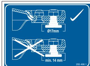
**U provedení se šroubovým uzávěrem nožů**
