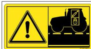
**Nebezpečí při nezajištěných řidicích ventilech traktoru**
