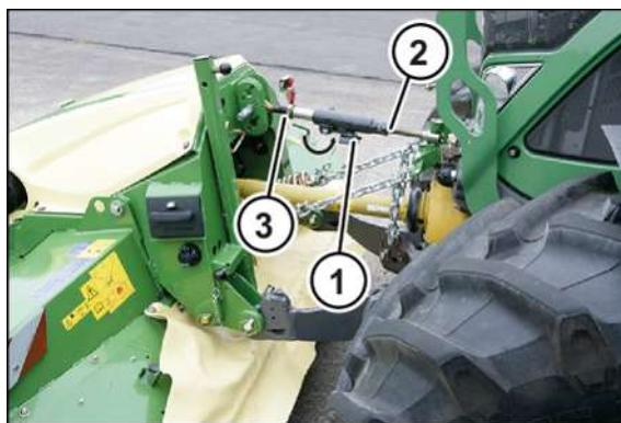
Aby se čelní žací ústrojí mohlo přizpůsobit terénu ve směru jízdy, lze jako zvláštní výbavu zakoupit teleskopické horní rameno.
