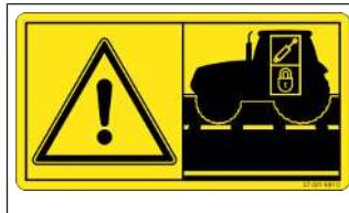
**Nebezpečí při nezajištěných řidicích ventilech traktoru**
