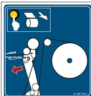
Pour installer le matériel de liage avec plus de confort, on peut déplacer la coulisse de filet vers l'avant soit avec la touche sur la machine, soit à l'aide du terminal, [voir Page 99](#).
