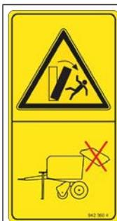
**Danger dû au mouvement inopiné de la machine lors de l'ouverture de la trappe arrière**
