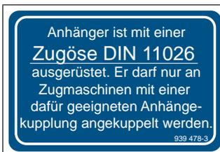
La remorque est équipée d'un œillet d'attelage DIN 11026. Elle peut uniquement être accouplée à un véhicule de traction dotée d'un attelage adapté à cet effet.
