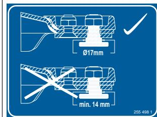
**U provedení se šroubovým uzávěrem nožů**
