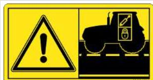
**Опасность из-за незаблокированных управляющих клапанов трактора**
