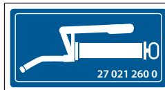
На машине имеются несколько точек смазки, которые необходимо регулярно смазывать, *см. Страница 213*. Скрытые места смазки дополнительно обозначены этой указательной наклейкой.
