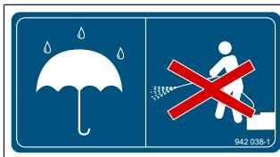
Участки, отмеченные этой наклейкой, должны быть защищены от брызг воды. В особенности запрещается направлять струю воды установки для чистки под высоким давлением на подшипники и компоненты электрики/электроники.
