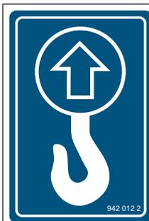
La machine comprend des points de levage identifiés par cet autocollant, [voir Page 88](#).
