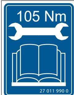
Эта наклейка указывает, что винтовые соединения должны быть затянуты с моментом затяжки 105 Нм.
