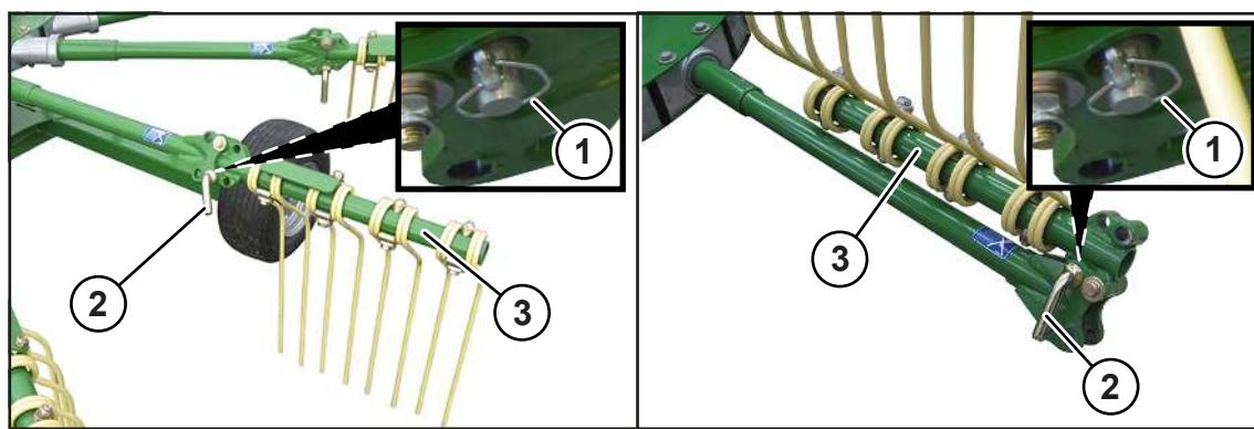
Складные граблины должны быть повернуты в транспортное положение в определенной последовательности.
