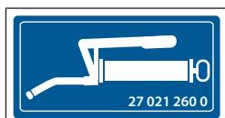
На машине имеются несколько точек смазки, которые необходимо регулярно смазывать, [см. Страница 106.](#) Скрытые места смазки дополнительно обозначены этой указательной наклейкой.
