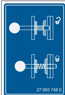
Наклейка находится на устройствах блокировки со стяжным болтом и показывает, какая блокировка открыта или закрыта.
