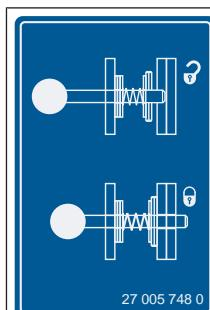
Tato samolepka se nachází na zajišťovacím mechanizmu vytahovacím čepem a uvádí, jak se zajišťovací mechanizmus otevírá nebo zavírá.
