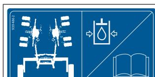
Tato samolepka uvádí, že se stroj obsluhuje pod hydraulickým tlakem a je nutné si přečíst provozní návod.
