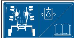
Tato samolepka uvádí, že se stroj obsluhuje pod hydraulickým tlakem a je nutné si přečíst provozní návod.
