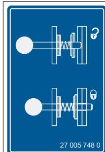
Tato samolepka se nachází na zajišťovacím mechanizmu vytahovacím čepem a uvádí, jak se zajišťovací mechanizmus otevírá nebo zavírá.
