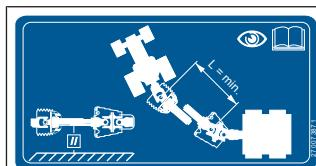
Samolepka se nachází v blízkosti kloubového hřídele a uvádí, že je třeba dodržovat při přizpůsobení hřídele provozní návod, viz [Strana 43](#).
