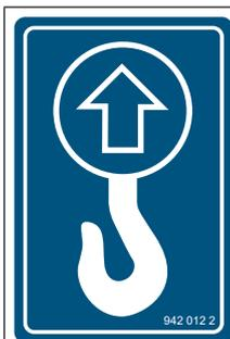
La machine comprend des points de levage identifiés par cet autocollant, [voir Page 220](#).
