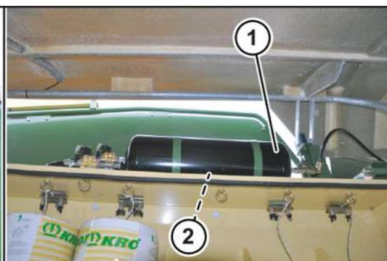
Réservoir à air comprimé pour le nettoyage du
