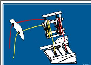
L'autocollant montre comment enfiler les ficelles de dessus jusqu'aux aiguilles supérieures, voir Page 120.
