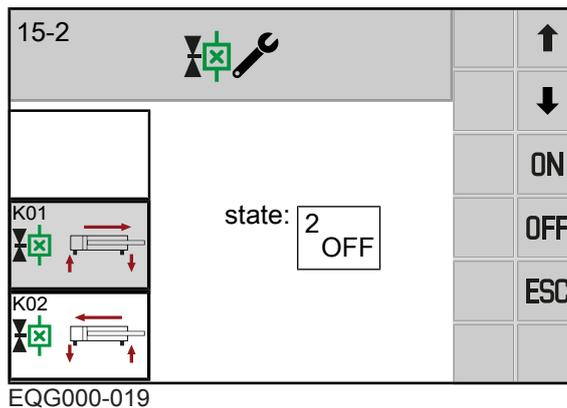
Les défauts ne sont affichés que si l'actionneur est activé et qu'un test est possible pour cet acteur. Le contrôle de la DEL du connecteur peut également être exécuté directement sur l'actionneur.
